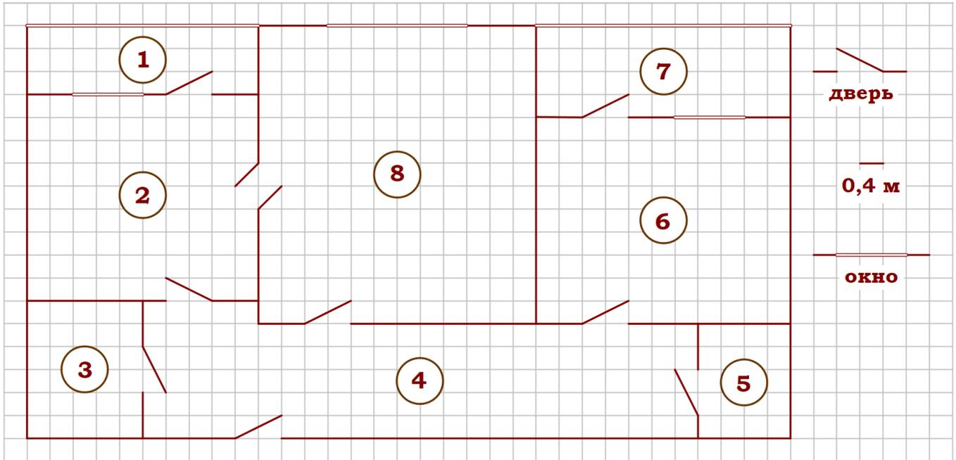
На рисунке изображён план двухкомнатной квартиры в многоэтажном жилом доме. Сторона одной клетки на плане соответствует 0,4 м, а условные обозначения двери и окна приведены в правой части рисунка.
